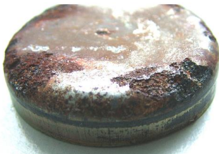
A6 Skorodowana zaślepka
