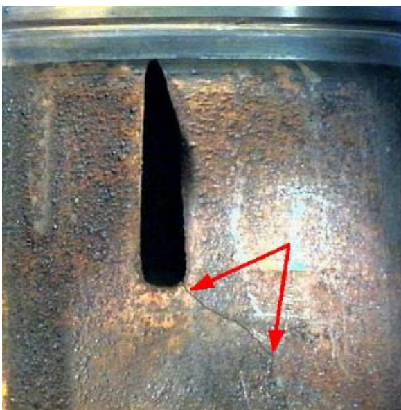
A2 Pęknięcie bloku silnika w obszarze gniazda tulei
