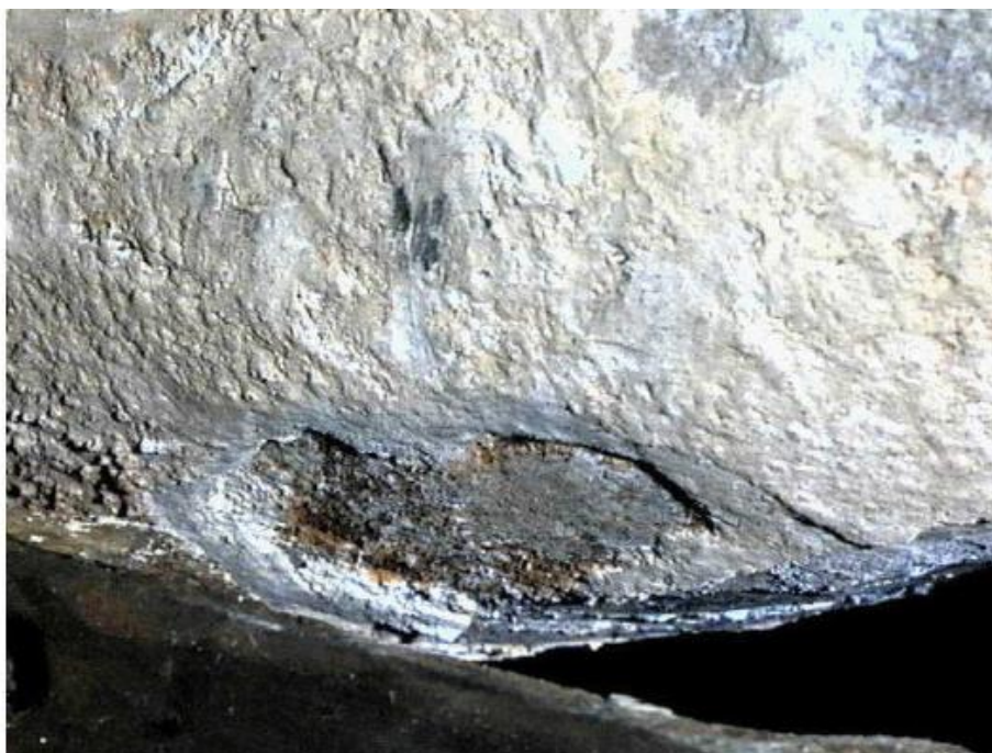
A8 Osad kamienia na tulei cylindra
